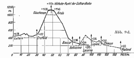
Abb. 9a bis 9d Die Längenprofile der drei wichtigsten West-Ost Bahnen und (zum Vergleich) der Gotthardbahn.
